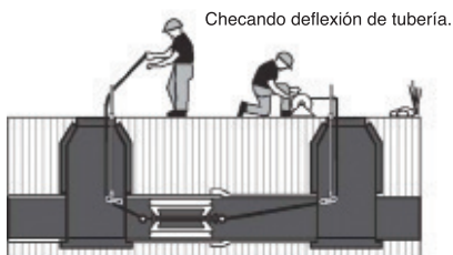
Figura 30. Prueba de paso de vía deslizado un mandril.
