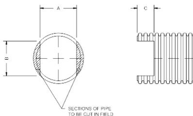
Las conexiones de tuberías de 250 mm (10") o más grandes requieren cortes en el campo para permitir una inserción completa. Corte el extremo de la tubería según se muestra en la imagen.
