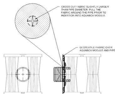
En el lugar de la conexión de la tubería, corte transversalmente el geotextil ligeramente más grande que el diámetro de la tubería. Las tuberías de conexión deben insertarse al menos 150 mm (6") dentro de la pared lateral.
