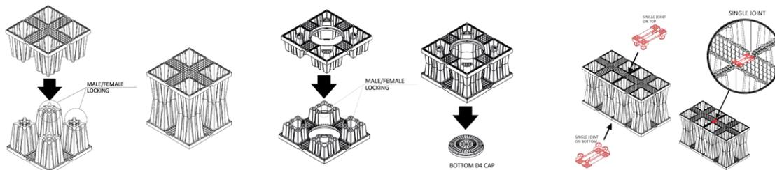
Cada módulo Aquabox consta de dos mitades. Ensamble los módulos colocando una mitad en el suelo, colocando la otra mitad encima y aplicando cierta presión para encajar la conexión. El ensamblaje puede realizarse dentro o fuera de la excavación.
