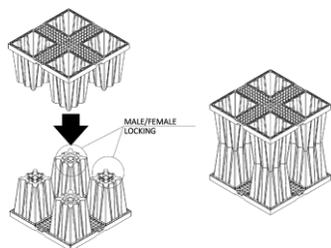
Para sistemas de múltiples capas, se utiliza la junta doble para enlazar módulos entre capas. Nota: la junta simple todavía se utiliza en las caras superior e inferior en estas configuraciones.
