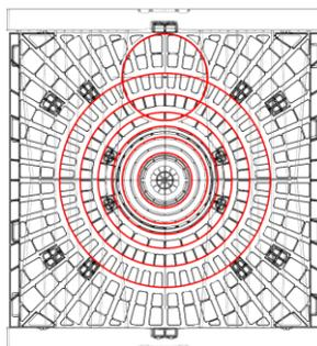
Las paredes laterales se pueden cortar para permitir conexiones de tuberías corrugadas de 100 mm (4") hasta 450 mm (18") de diámetro. Las paredes laterales deben cortarse antes de ser instalados en los módulos.
