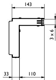
Revisionsschacht 3S / revision shaft 3S, Heelproof, SW 3x6mm, SH 110, C250
