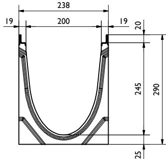
FCT pro NW200 G, Nr. 5-0 f. seitl. Bohrung/f. side outlet drilling
