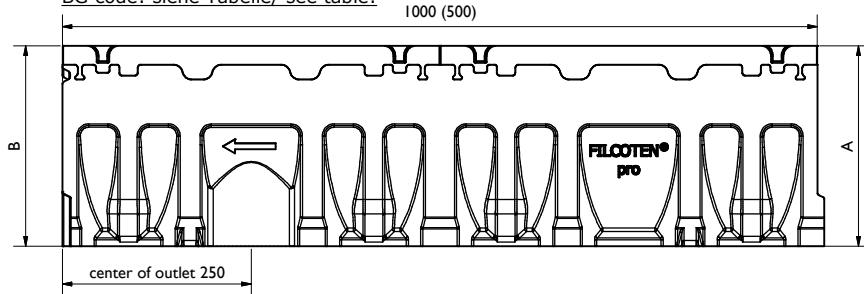
FCT pro NW200 V, Nr. 5-0 f. seitl. Bohrung/f. side outlet drilling
