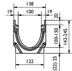
FCT pro NW100 V-E, Nr. 5-0 f. seitl. Bohrung/f. side outlet drilling
