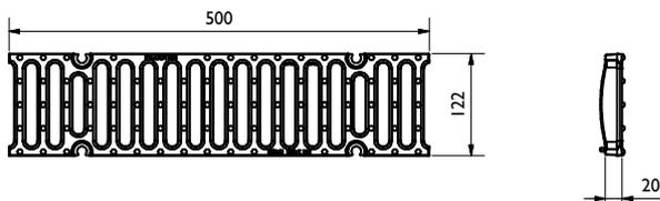
Schlitzaufsatz / slot top NW 100:
