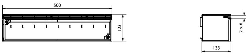
Schlitzaufsatz 3S / slot-top 3S, Heelproof, SW 3x6 mm, SH 110, C250
