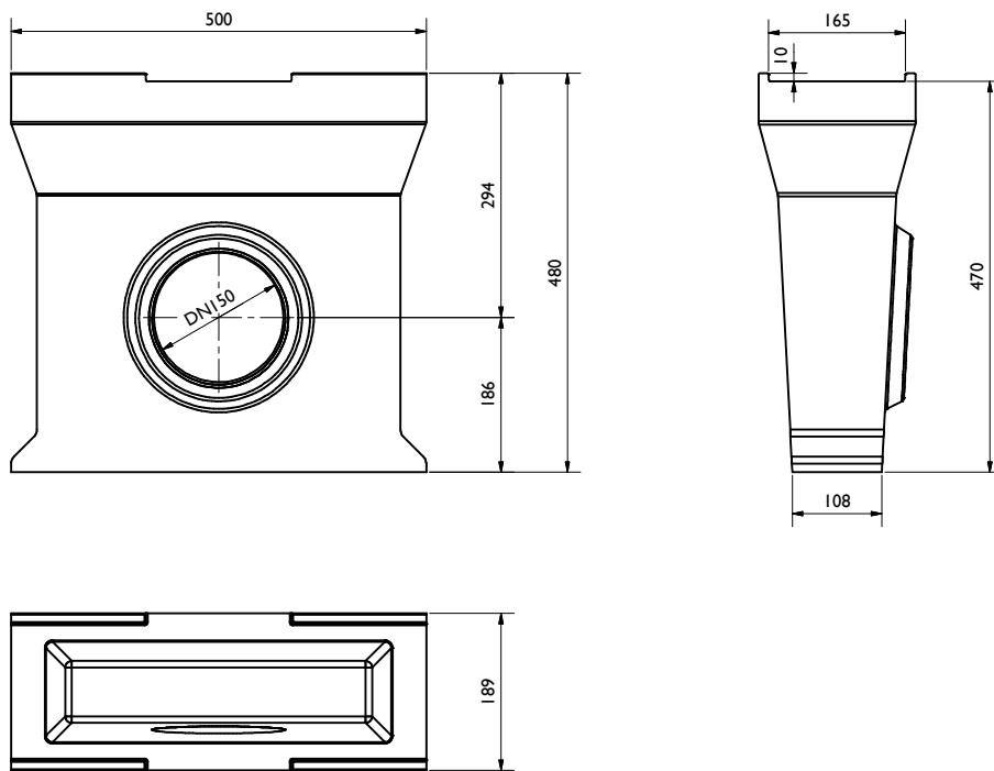
Zusammenbau Sinkkasten Oberteil und Unterteil DN150 /
