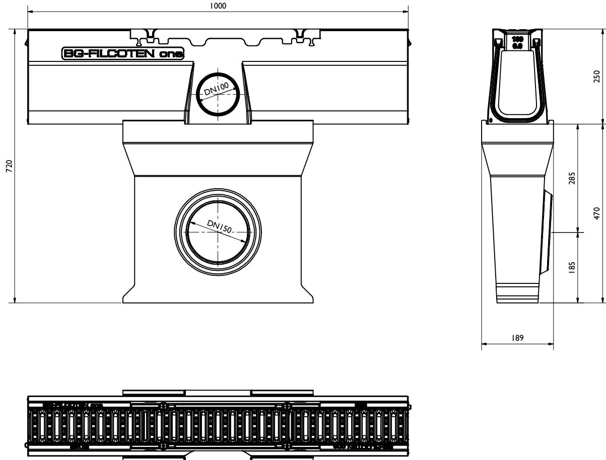
Sinkkasten einteilig DN150 / one-piece sump unit DN150:
